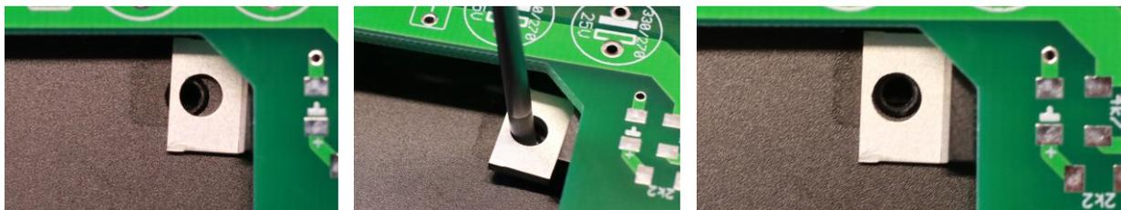
Die Regel-Transistoren liegen oft nicht exakt auf den Bohrungen im Boden, können aber leicht passend hingezogen werden, z.B. mit TORX T8 (siehe das mittlere Bild). **Vor der Befestigung die Isolierung unterlegen.** Anschließend kann per Multimeter zwischen einer beliebigen Schraube im Boden und dem silbernen Teil des Transistors überprüft werden, dass keine leitende Verbindung zum Boden besteht. Zum Schluss alle Schrauben fest anziehen.
