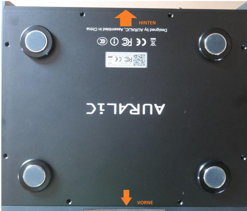
**Bild 2:** Kupfer-Gehäuse Innen. 6 Schrauben TORX T10 lösen, Deckel abnehmen.
