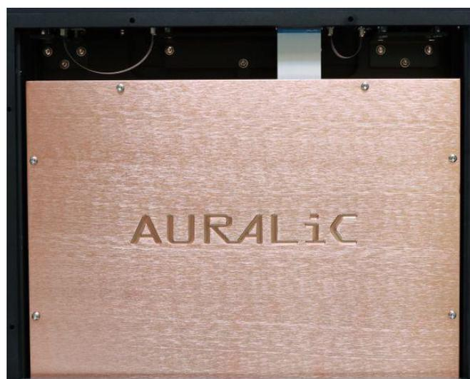
**Bild 3:** Deckel des Kupfer-Gehäuses abgenommen.
