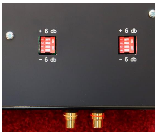
Bild 1: Die Schalter zur Eingangs-Abschwächung des KH – AMP auf der Unterseite
