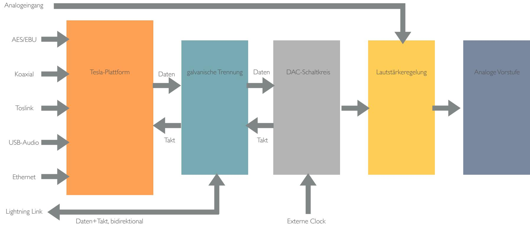
Alle digitalen Eingänge gelangen zunächst in die verbaute Tesla-Plattform, werden quasi „aufgenommen“. Vom DAC getaktet werden Sie weitergeleitet. Das analoge Signal wird unmittelbar zur Lautstärkeregelung geleitet.
