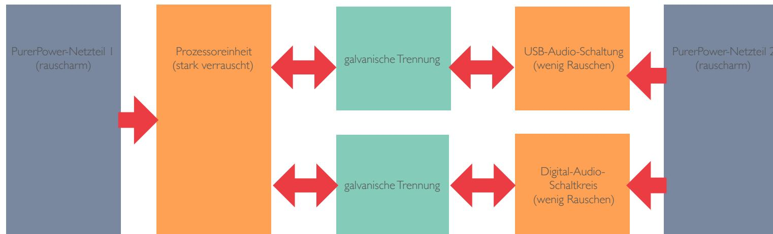
Im ARIES G2 arbeiten gleich zwei der von uns entwickelten Purer-Power-Netzteile. Auch diese sind aufgrund AURALiCs Obsession, jegliche Störungen und Rauschen zu unterdrücken, galvanisch voneinander getrennt. Der Prozessor und die Stromversorgung für das Display sind so komplett von empfindlichen Audio-Schaltungen abgetrennt, die separat versorgt werden. Interferenzen sind so auf Null reduziert, sodass Sie nur eines hören: Die Musik.
