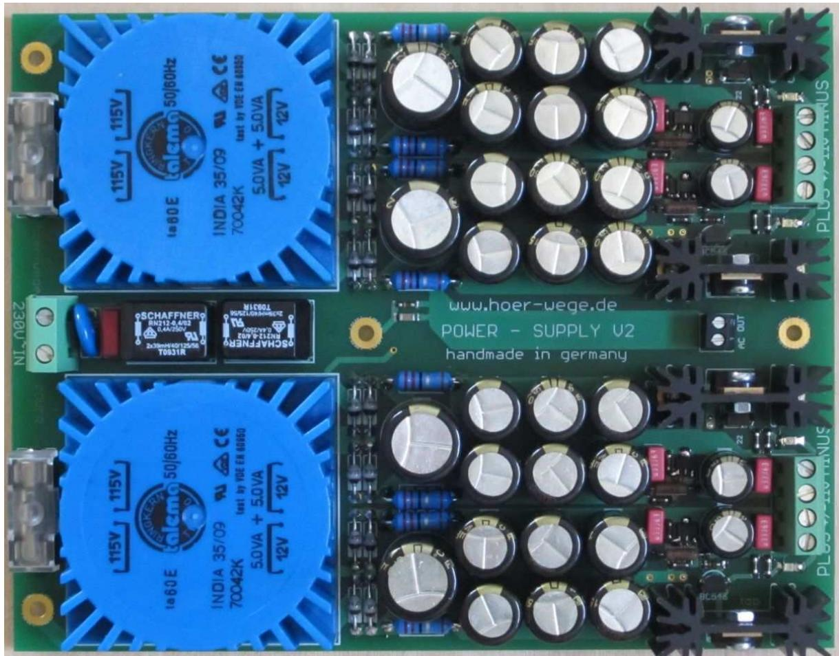
Links die beiden vergossenen RK-Trafo, davor die Sicherungen mit 80mA-T. Zwischen den beiden Trafos die Filter. Nach dem Netzkabel vollständig kanalgetrennter Aufbau, mit separater "Erzeugung" von PLUS und MINUS. Sehr rausch- und störarme Spannungs-Regelung mit ausgesuchten, diskreten Bauteilen.
